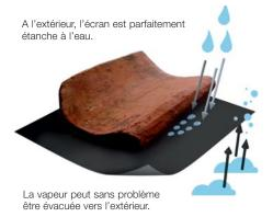
En outre, grâce à sa stabilité élevée aux UV, cette membrane est extrêmement appropriée comme écran de sous-toiture en cas d'utilisation de tuiles de récupération, qui laissent généralement filtrer beaucoup de lumière à hauteur des chevauchements.
