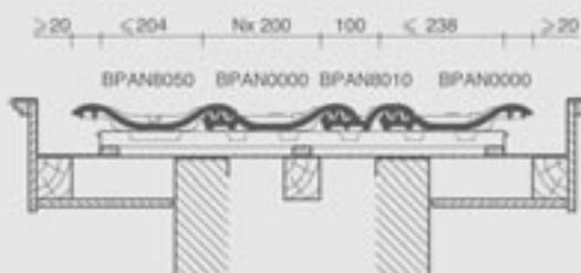
**Plan de pose transversale de la toiture au niveau de la tuile de rive**
